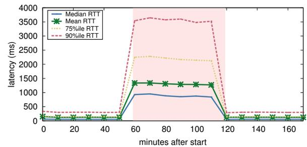
(d) Experiment I: 90% packet loss (60 s TTL)
